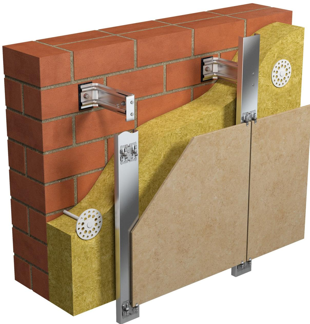
Воздушный зазор между наружной поверхностью утеплителя и внутренней поверхностью облицовки не должен быть менее 40 мм и превышать 200 мм; при этом должен быть обеспечен воздушный зазор не менее 20 мм между наружной поверхностью утеплителя и вертикальной направляющей.
