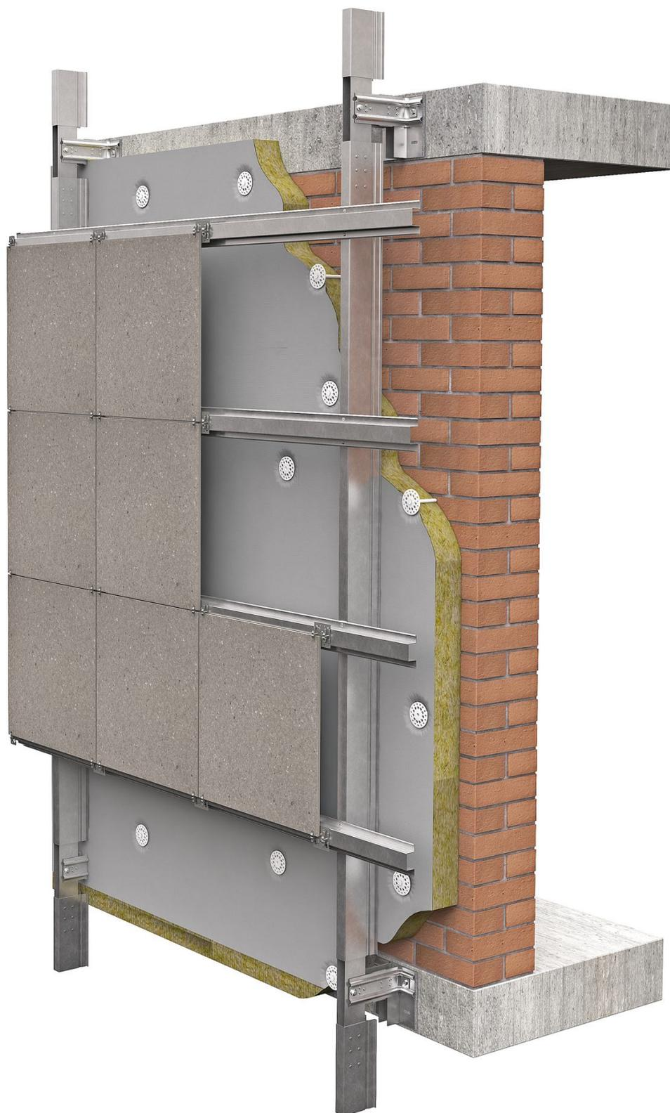
Воздушный зазор между наружной поверхностью утеплителя и внутренней поверхностью облицовки не должен превышать 200 мм; при этом должен быть обеспечен воздушный зазор не менее 20 мм между наружной поверхностью утеплителя и вертикальной направляющей.
