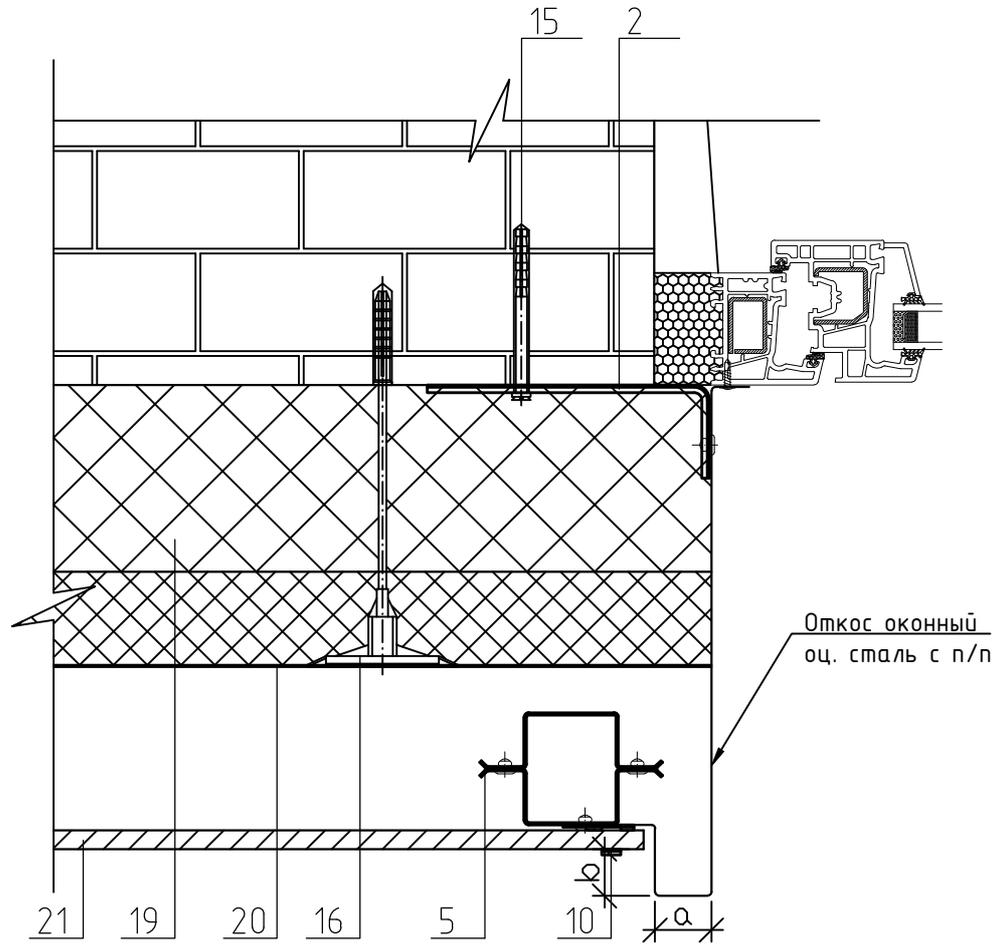
Необходимость установки двойной направляющей 50x30x1.2 вдоль докового примыкания к оконному проему определяется проектом
