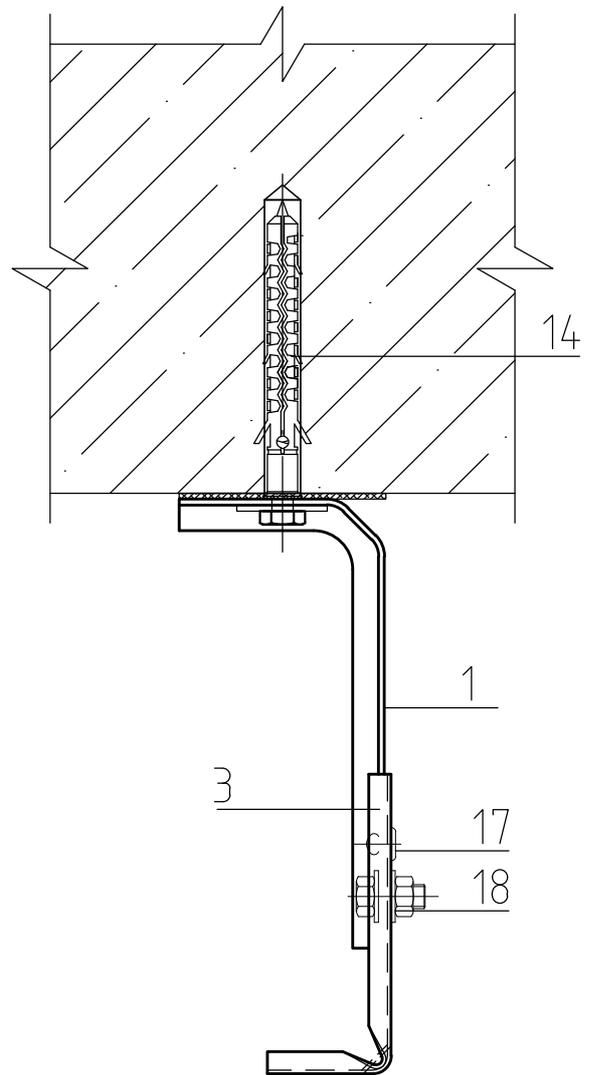
Схемы сборки конструкции кронштейн-удлинитель равнозначны.
