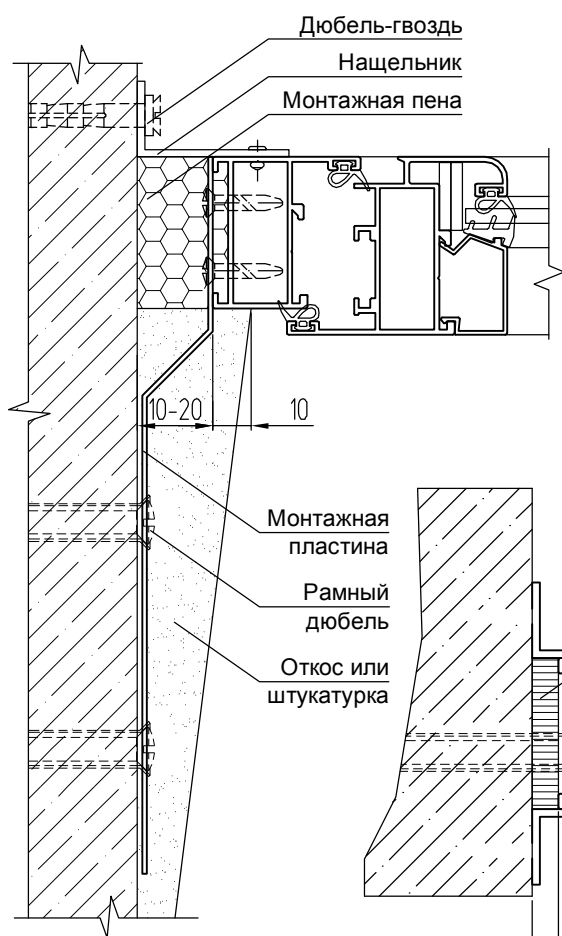
Вариант монтажа с помощью монтажных пластин
